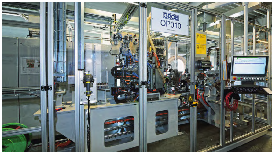
图2 导线绕组的生产准备工作：做好发夹式电动机绕组的所有准备工作
