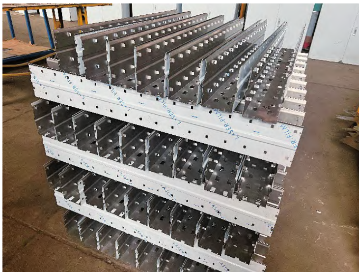
图4 需要 16 道折弯的不锈钢钣金提篮
