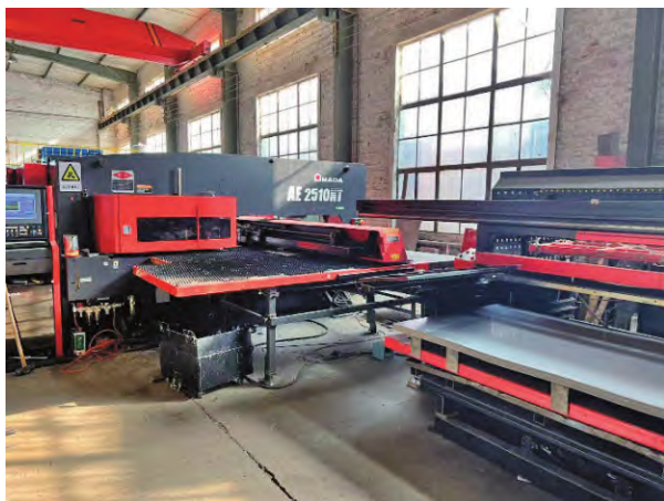
图3 可以实现上下料工序无人化作业的 AE2510+MP2512 数控冲床解决方案
