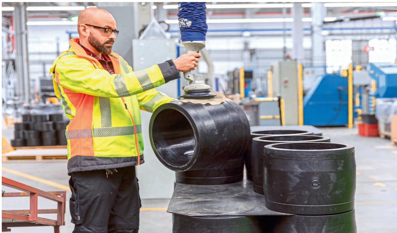
图 2 带有硅橡胶唇边的吸盘可以旋转 90°，允许操作者手动调整被吸取的零部件。尽管粗短的套筒表面呈弧形，仍然可以被牢牢地吸取起来
