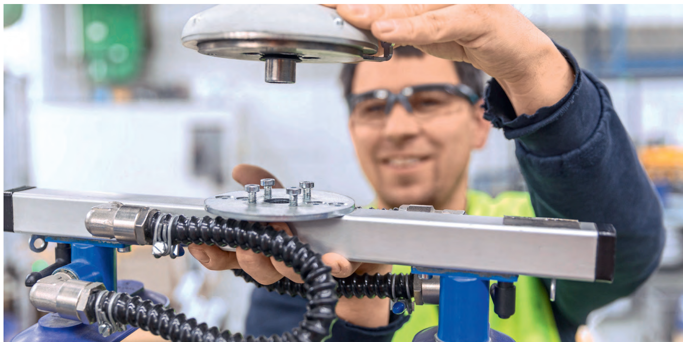
图 1 用纸箱装运焊接设备：为了符合人体工程学的原理将焊接设备吊起来，吊装工人简单地更换了双吸盘吸头
