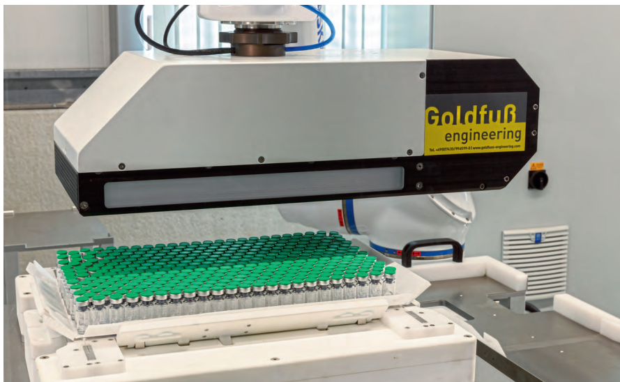
图 1 小小的玻璃瓶：医用安瓿瓶的自动化运输需要非常轻柔的专用真空器具
