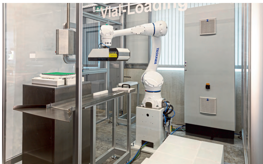
图 2 在 Goldfuß 公司的研发生产工作室内，机器人成功地运送着敏感易碎的安瓿瓶
