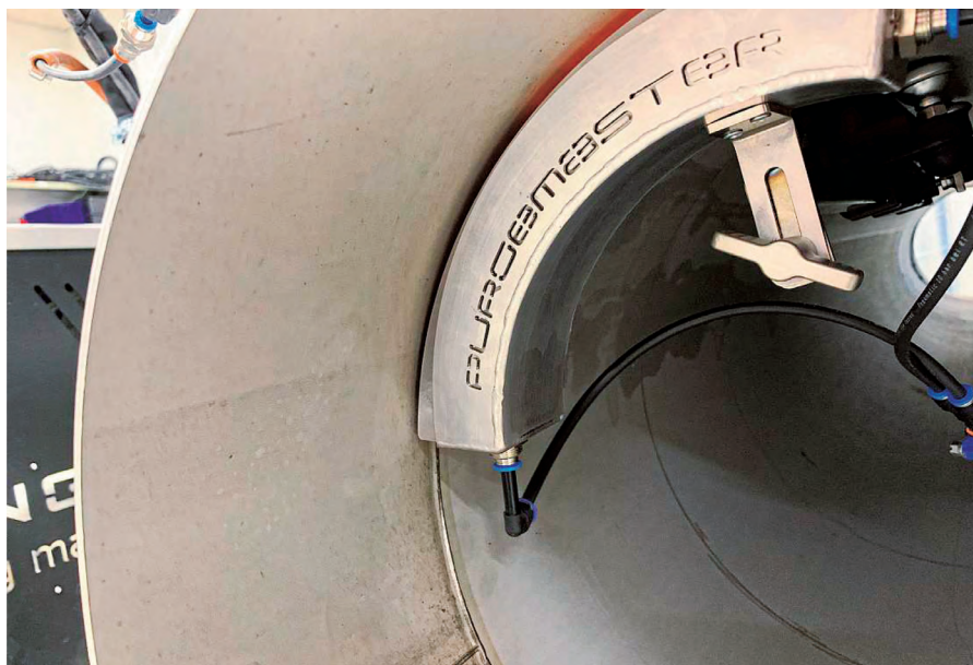
在使用 Welding Droid 公司研发生产的 Purgemaster 系统时，只有在需要氮氢混合气体时才用氮氢混合气体进行冲洗
