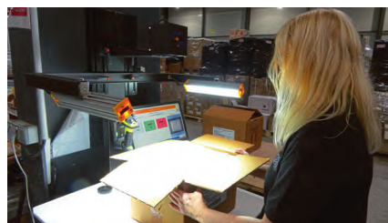
图 4 Tedis 公司利用 Zetes Media Image 自动读取和记录数据矩阵代码中的信息，确保了药品的可追溯性
