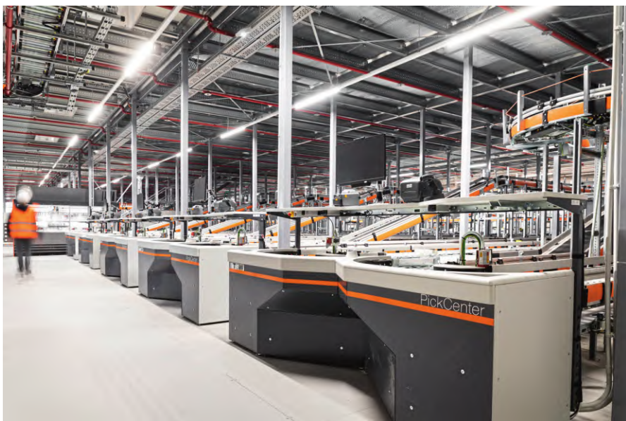
图 1 总长 14 km 的输送线确保了物流高峰日每天能够运输 10 万多件物资（HU）
