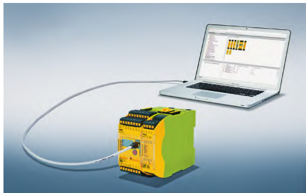
图 1 PNOZmulti 2 通过双通道操作，确保了安全装置的可靠运行
