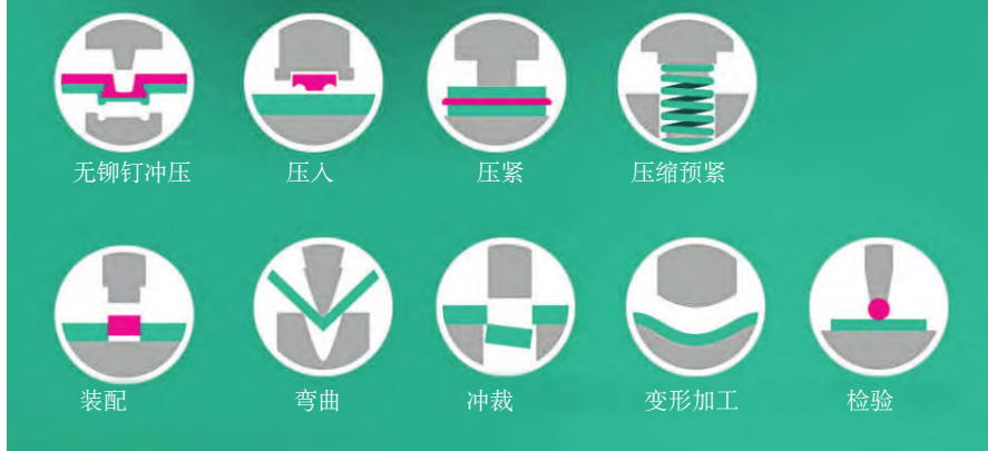
图 2 利用 Tox 公司的无铆钉连接技术可以轻松地完成永久性的电气和机械连接，必要时也可以实现很好的气密性和水密性
