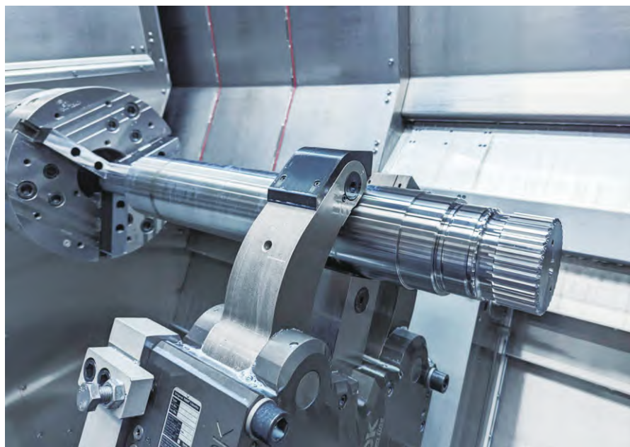
图 2 一个驱动轴工件通过 Flank-Hob 进行滚齿加工，WFL 循环用于外齿切削
