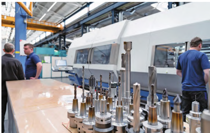
图 3 加工的可能性范围覆盖全面，这需要大量的加工刀具。这台机床配备了可靠的 107 把刀位的盘式刀库。长度 500 mm，直径 160 mm 以下的刀具均可在此使用
