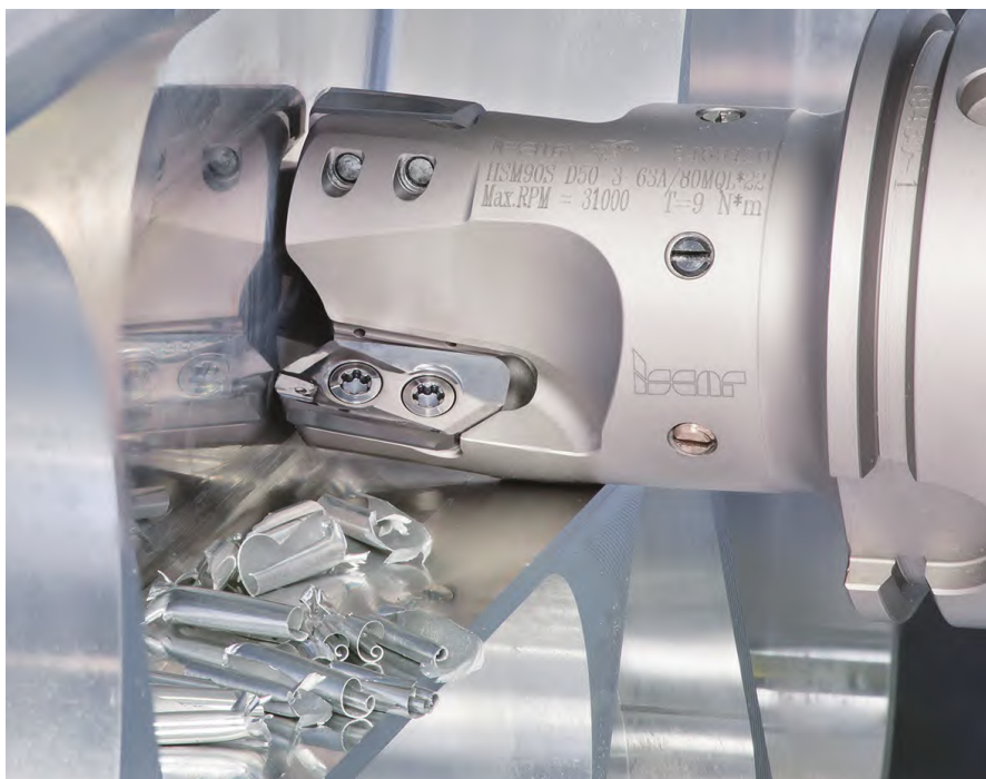
图 2 可转位铣刀，用于在极高切削速度下加工铝，专门设计用于抵抗由于离心力而可能产生的刀片径向位移
