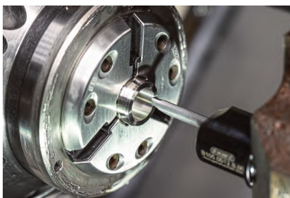
图 1 微米级加工精度和极高的表面质量确保了斯特林发动机的工作运行
