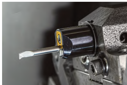
图 2 Böhm 公司加工内孔时使用的是 Horn 公司研发生产的 Supermini 105 系列的车削刀具
