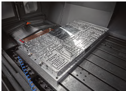
图 2 各个零件都在五面切削加工中几乎达到了成品的最终尺寸
