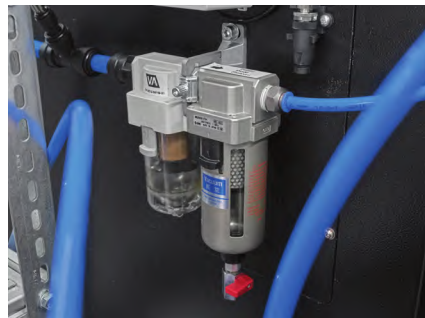
图 4 真空系统采用了灵敏度很高的液体分离器和带传感器的压力监控器
