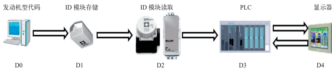
图 2 发动机机型切换提示系统原理
