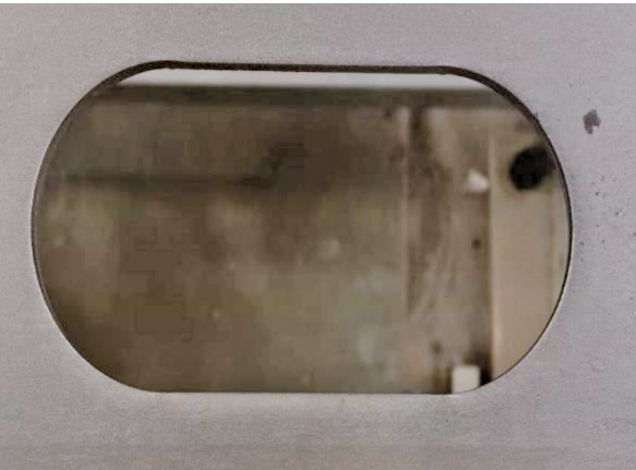
图5 矩形冲头冲孔后效果示意
