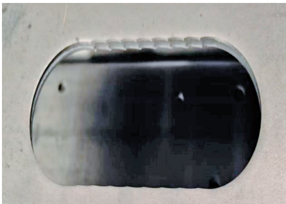
图 3 \phi 60 \text{ mm} 孔连续冲孔效果
