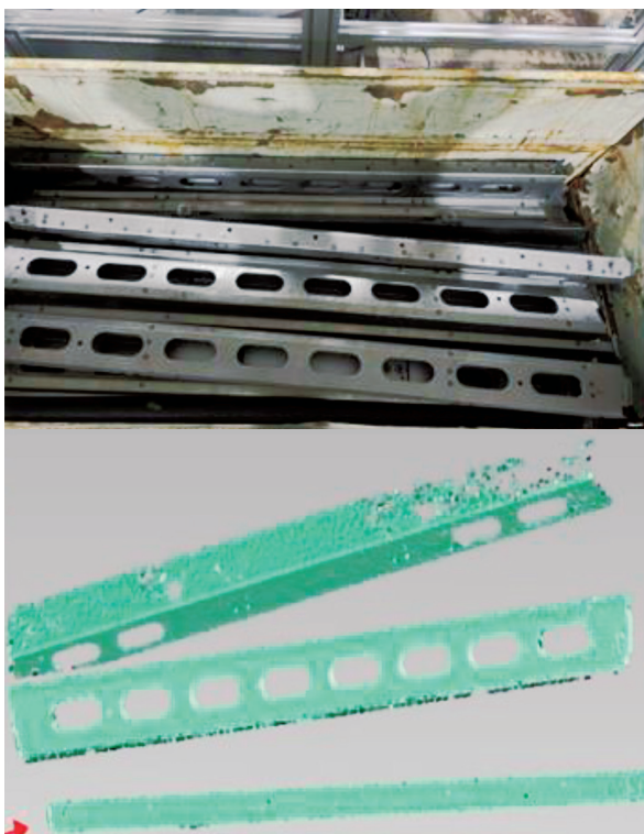
图4 3D视觉系统扫描物料示例
