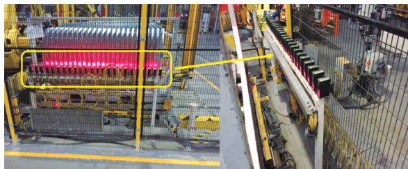
图 2 接近开关进行物料响应示例
