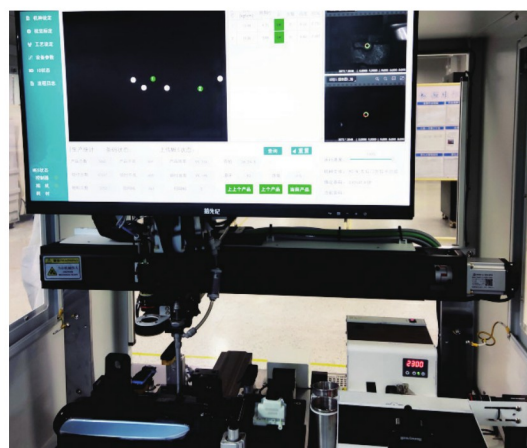
图6 视觉引导螺钉紧固
