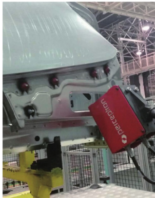
图2 205 perceptron后杠焊钉自动检测
