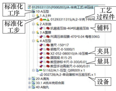
图2 工艺 BOP 结构树
