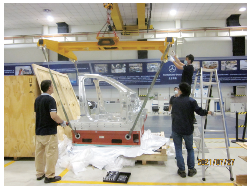
图3 Cubing组装吊装
