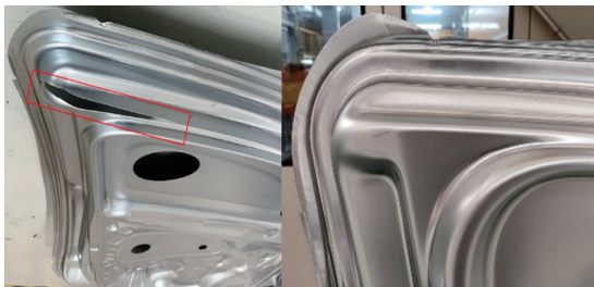
图6 某前门内板B柱开裂及对应拉伸收料线调整状态
