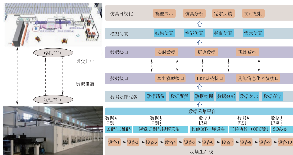
图2 基于MBSE的智能生产系统框架
