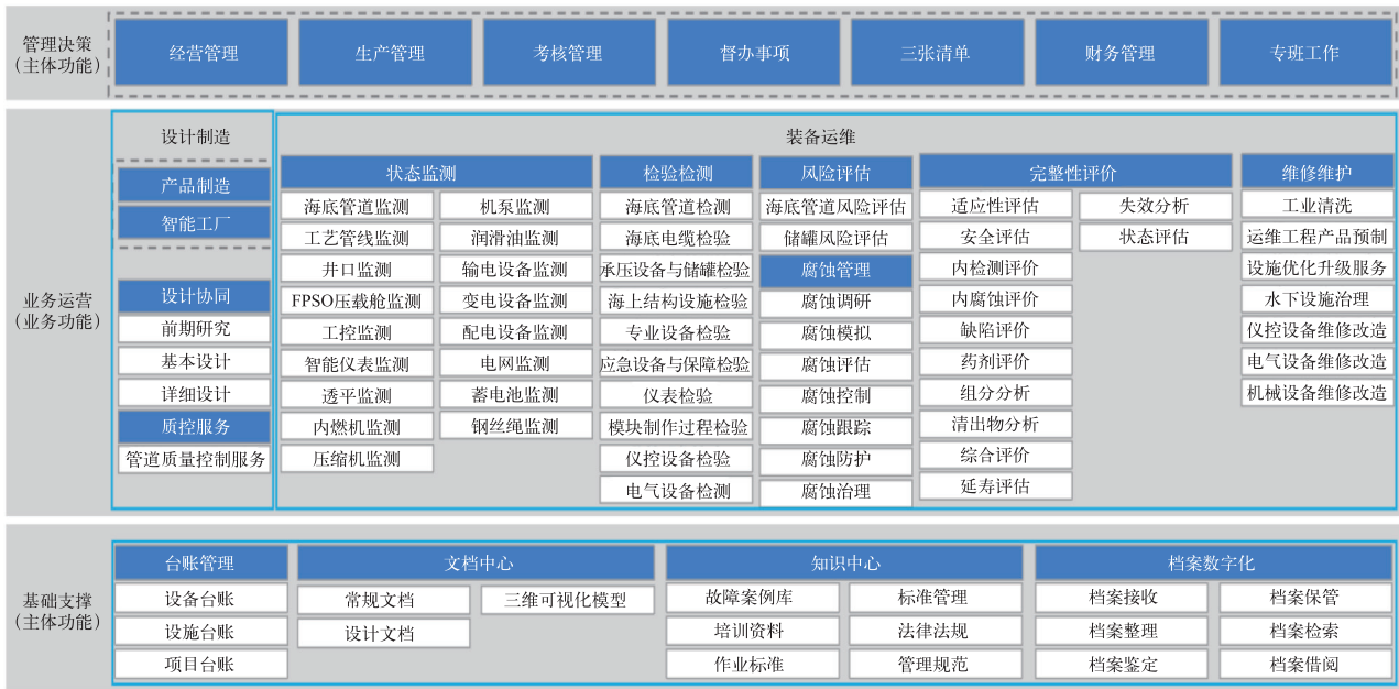
图 3 某智能制造基地设备设施预测性防治应用架构
