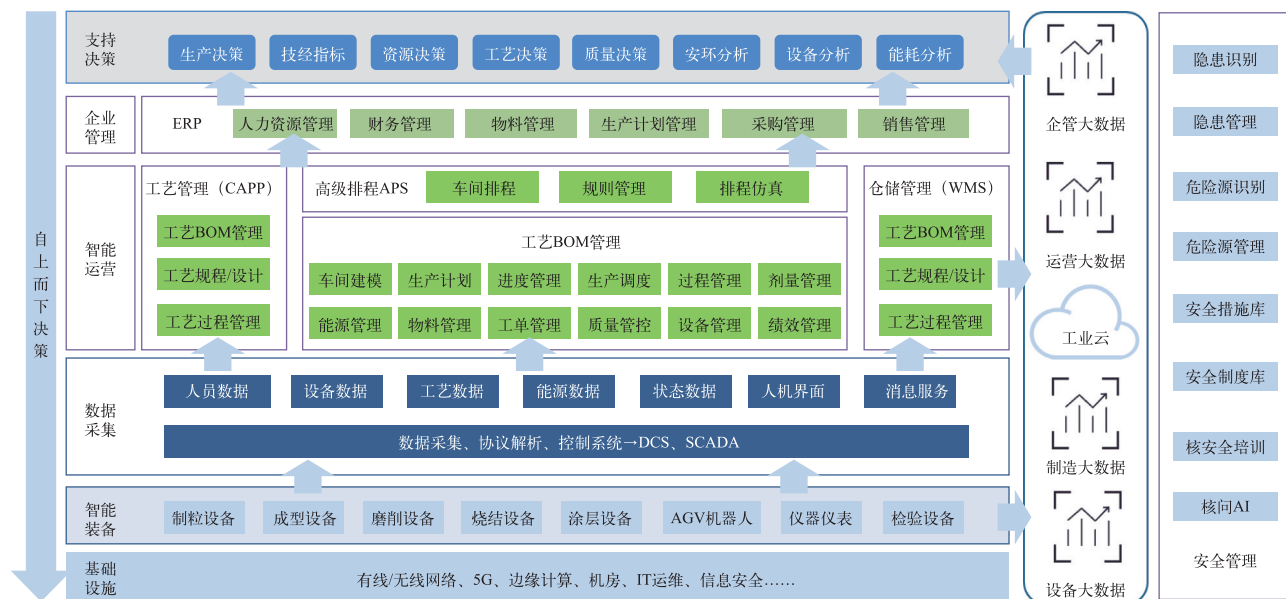
图4 智能车间数字化架构图
