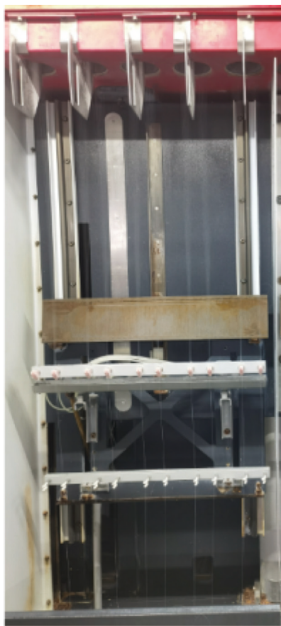
图2 侧吹纺丝箱体丝路巡检成像图
