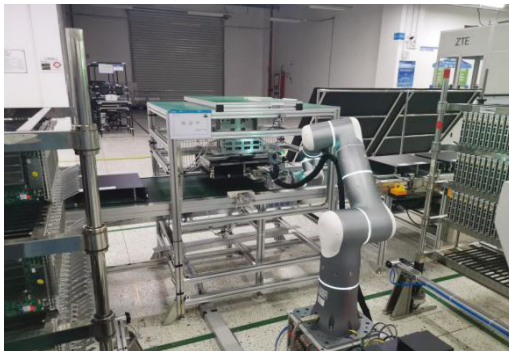
b) ITBBU单板自适应配板工位实际作业图
