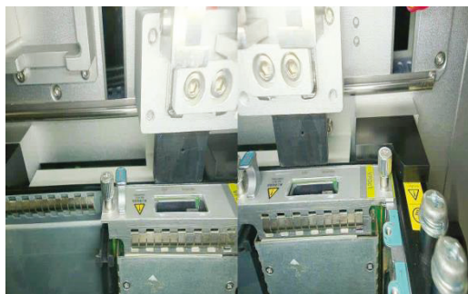
a) 机器人免编程插拔电源接头示意图
