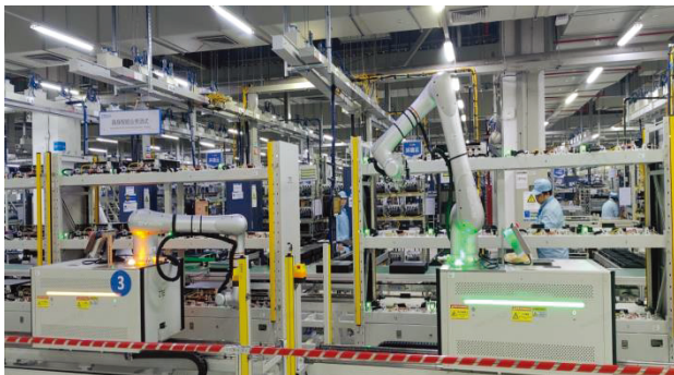
b) ITBBU整机测试自动柔性插拔线缆工位实际作业图
