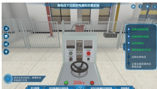
(a) 变压器升压操作
