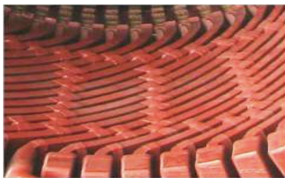
图2 绑扎式端部绕组结构
