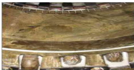
图3 整体灌注式端部绕组结构
