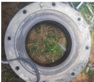
图6 失效的硅胶防水层
