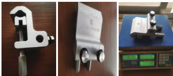
图5 研制的金具无绝缘罩的实物图
