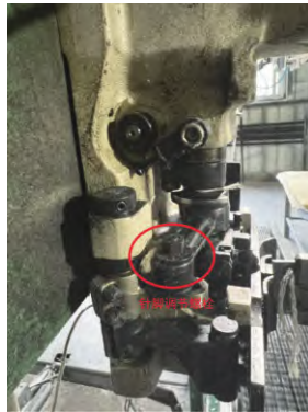
图3 缝口单元针脚调整螺栓
