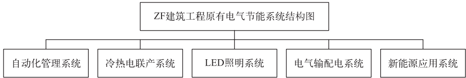
图1 ZF工程电气节能控制系统基本结构图
