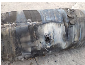
图2 某公司35 kV中间接头相接地故障
