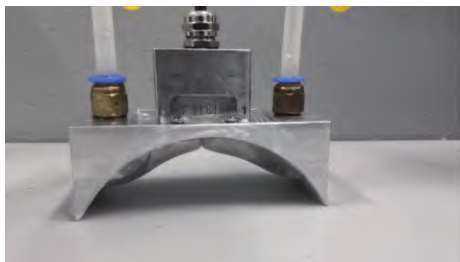
图7 相控阵柔性探头实物图
