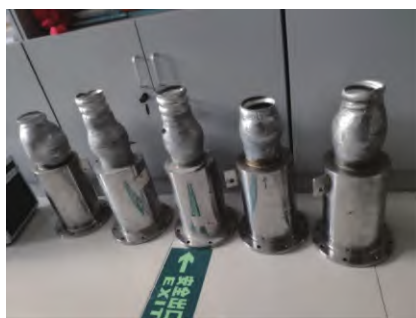
图4 铅封试样实物图
