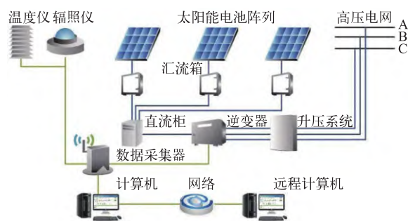
图1 光伏电站智能监控系统架构图
