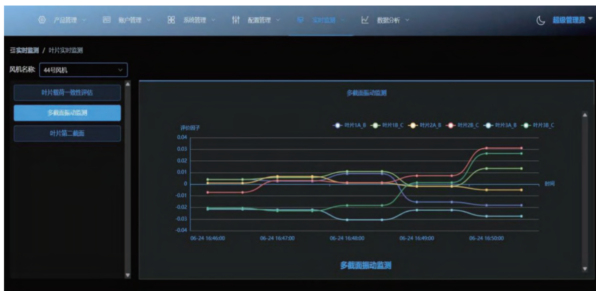
图4 叶片状态监测系统的多截面振动监测
