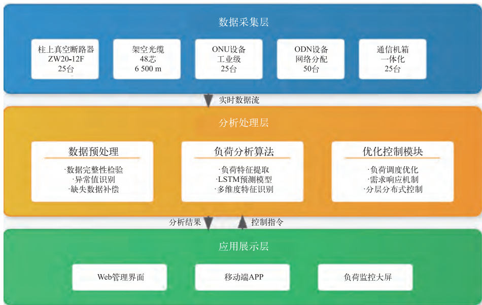
图2 智能电网低压负荷动态分析系统架构
