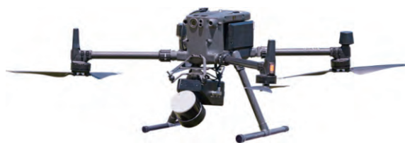
图2 LiAirX4自主飞行激光雷达采集系统
