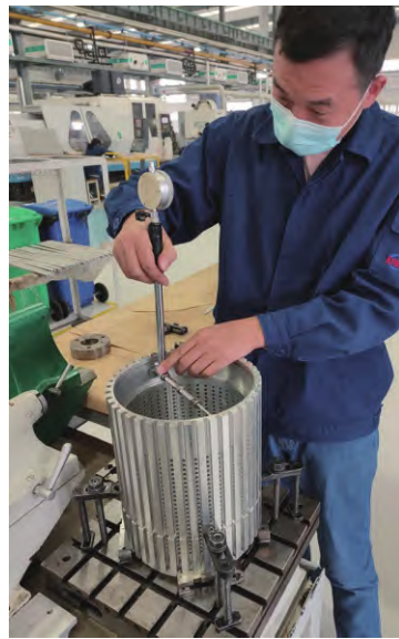
图4 监测立式装夹方式零件变形
