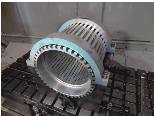
图3 改进前卧式镗孔装夹方式
