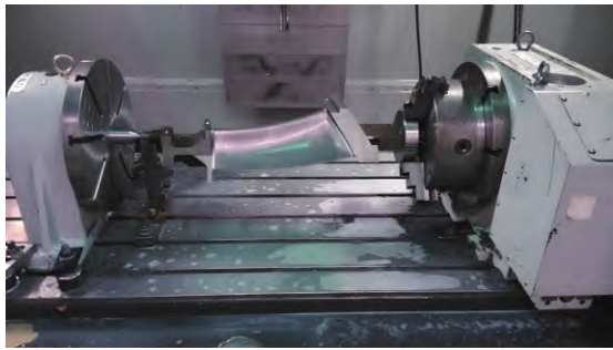
图14 叶片在机床实际加工
