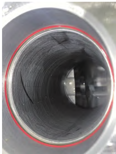
图1 缸孔表面产生振纹
