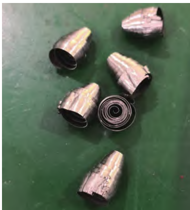
b) 加工程序改进后的切屑
