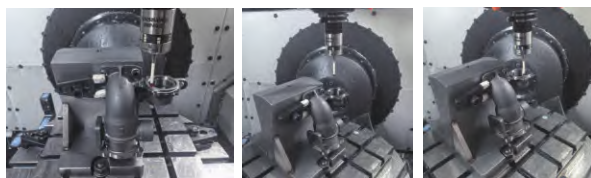
a) 自动采点 b) 自动跟踪 c) 设置精坐标系
