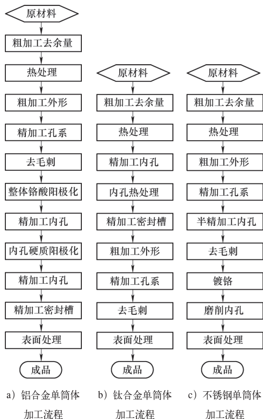
图1 单筒体加工流程图
