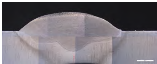
图10 试验件进行强化后的接头截面
