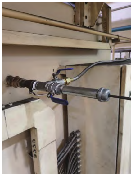
图7 改造后定碳结构实物
