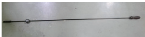
图9 改造后定碳杆实物
