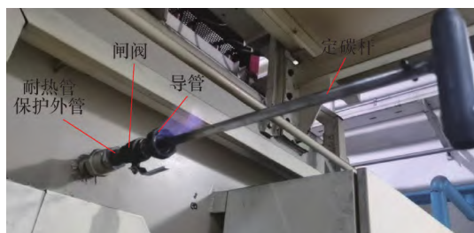
图1 原定碳结构实物
