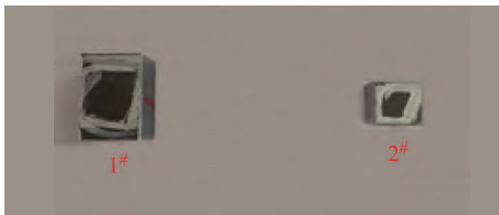
图15 缺陷区域制取高倍检验试样
