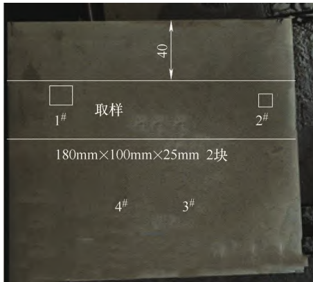
图14 断口试验试样取样位置
