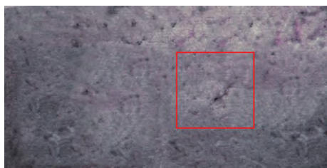
图5 低倍横向缺陷宏观形貌
