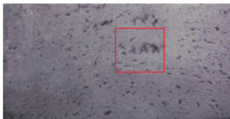
图4 低倍纵向缺陷宏观形貌
