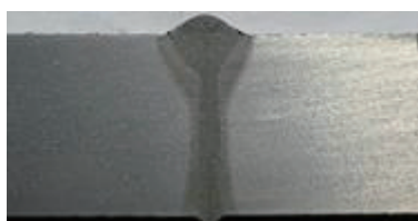
图4 激光-电弧复合焊接头截面宏观形貌
