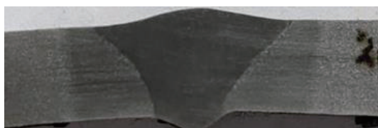
图8 双丝MAG电弧焊接头截面宏观形貌
