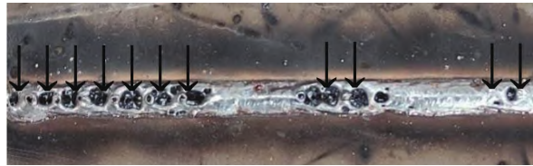
图11 双丝MAG电弧焊焊缝表面气孔
