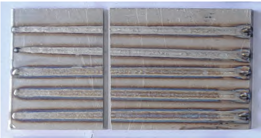
图3 被切断的焊缝
