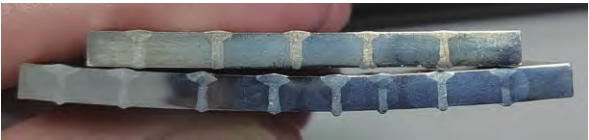
图5 两种焊接方法的焊缝截面对比
