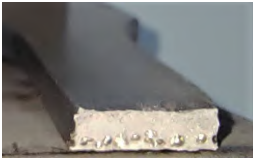
图1 试样断口上的气孔
